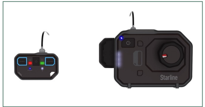
Figura 4: En las unidades con cable, conecte el cable de fibra óptica a la herramienta del actuador y al controlador remoto. Las unidades inalámbricas vienen vinculadas de fábrica. Pulse el botón de encendido en cada dispositivo. Las luces de estado parpadearán. Las luces verdes fijas indican que los dispositivos están vinculados y listos para la activación.
