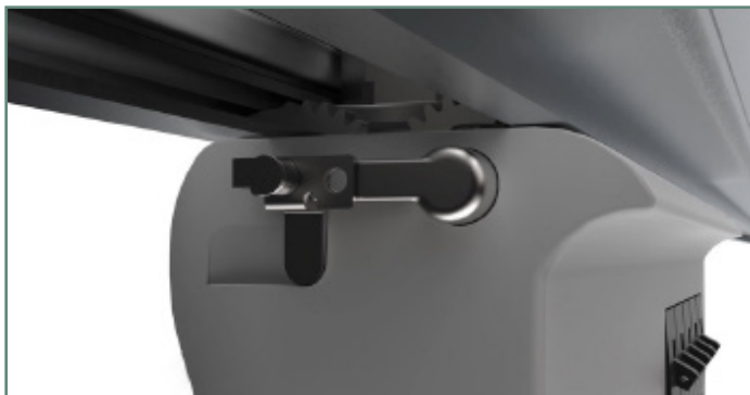
Figure 1 : Installez l'unité enfichable dans la barre blindée. Assurez-vous que les loquets situés des deux côtés du boîtier sont fixés.
