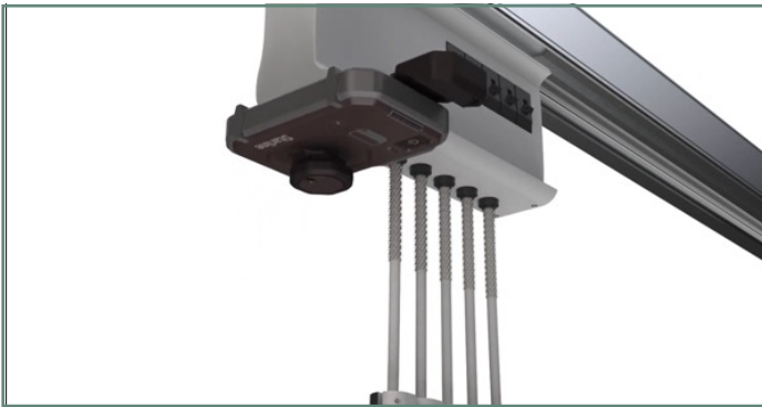
Figura 3: Presente la herramienta del actuador y asegúrela con firmeza en la unidad de conexión. Comprima el mango del actuador y empuje el bloqueo tipo bayoneta de nuevo a su posición. El actuador debe quedar firmemente asentado.
