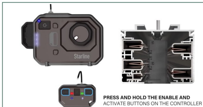
Figura 5: Despeje la zona de arco eléctrico. Mantenga pulsados los botones de habilitación y activación en el controlador remoto para comenzar la activación de la unidad de conexión. Mantenga los botones pulsados hasta que la unidad de conexión se haya acoplado por completo. Esto se indica mediante una luz roja fija.
