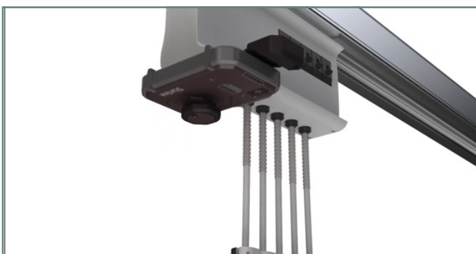
Figure 3 : Soulevez l'outil d'actionnement et insérez-le fermement dans l'unité enfichable. Comprimez la poignée d'actionnement et remettez le verrou à baïonnette en position. L'outil d'actionnement devrait être bien en place.
