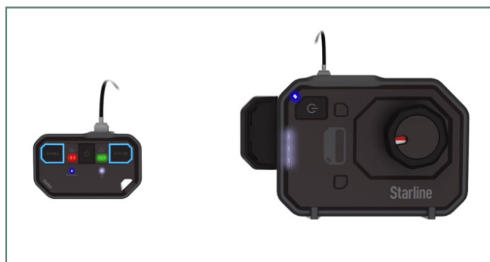
Figure 4 : Pour les unités filaires, raccordez le câble à fibre optique à l'outil d'actionnement et à la télécommande. Les unités sans fil sont pré-appairées en usine. Appuyez sur le bouton d'alimentation de chaque dispositif. Les voyants se mettent à clignoter. Des voyants verts allumés en continu indiquent que les dispositifs sont appairés et prêts à être activés.
